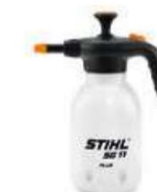
Pulverizador manual com tubeira regulável para pulverizar detergentes e dissolventes, por exemplo CB 50, Superclean ou Varioclean. 1,5 litros de capacidade de depósito, pressão máxima 3 bar, juntas EPDM para detergentes e dissolventes numa escala de pH de 7-14. Protetor especial da bomba que prolonga a sua vida útil.
